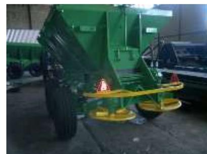
Привод транспортера осуществляется через гидродвигатель РПГ, привод рассеивающих дисков через ВОМ трактора или также возможно гидравлическое через гидромотор МГП.
